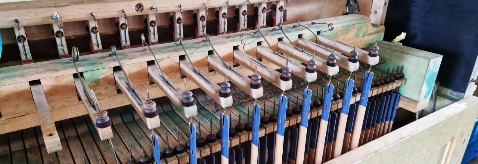
- Pohľad na dvojramenné páky z registrovej traktúry v hracom stole pred opravou
